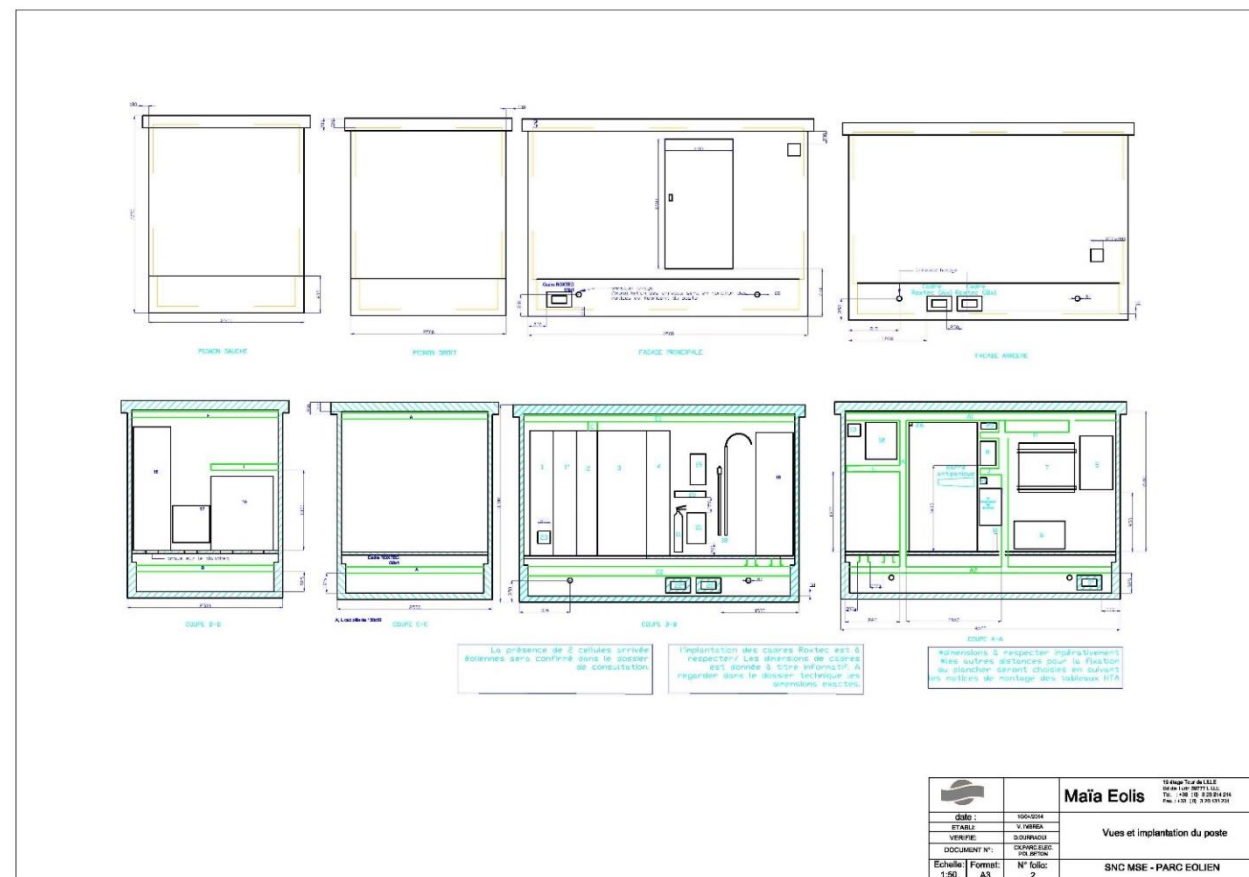
Figure 9 : Vues du poste de livraison envisagé pour l'extension du parc éolien de Coyecques (source : Maïa Eolis, 2014)
